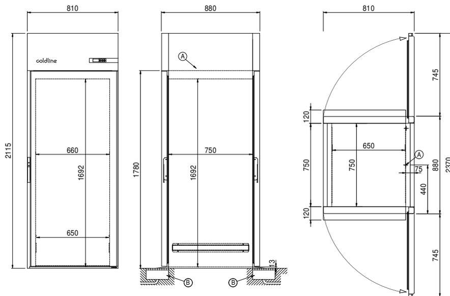
A: Alimentación del cable de salida
