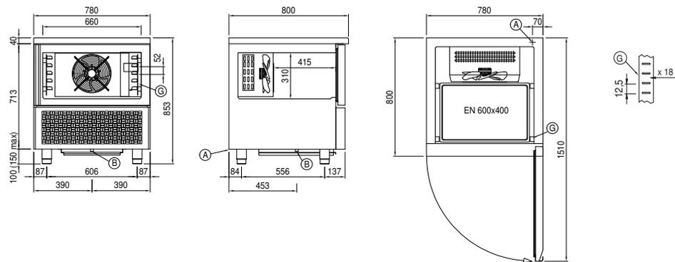
A: Alimentación del cable de salida      B: Descarga del agua de condensación      G: Cremalleras
