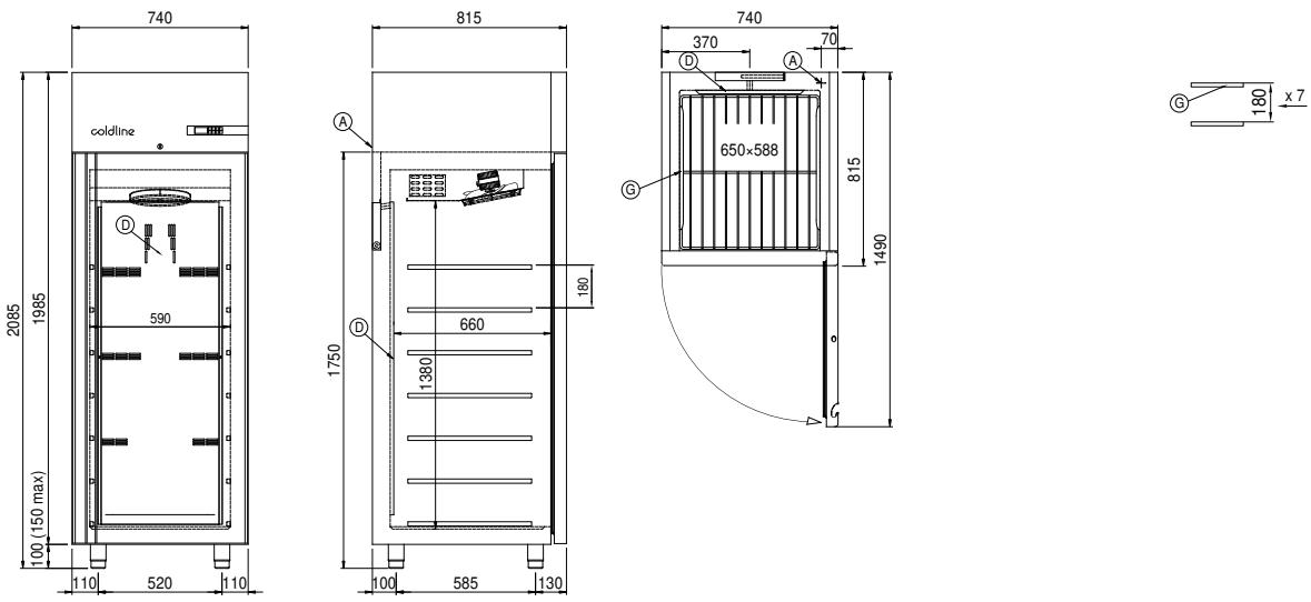
A: Alimentación del cable de salida
