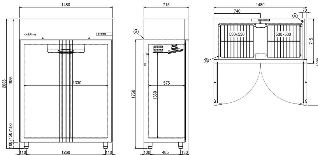
A: Alimentación del cable de salida
