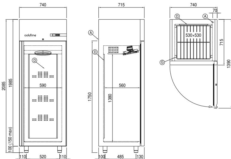
A: Alimentación del cable de salida
