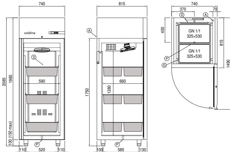
A: Alimentación del cable de salida
