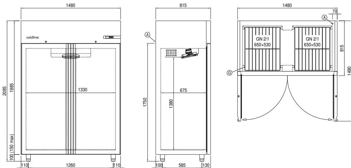
A: Alimentación del cable de salida
