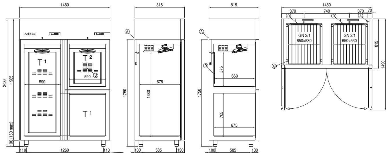
A: Alimentación del cable de salida
