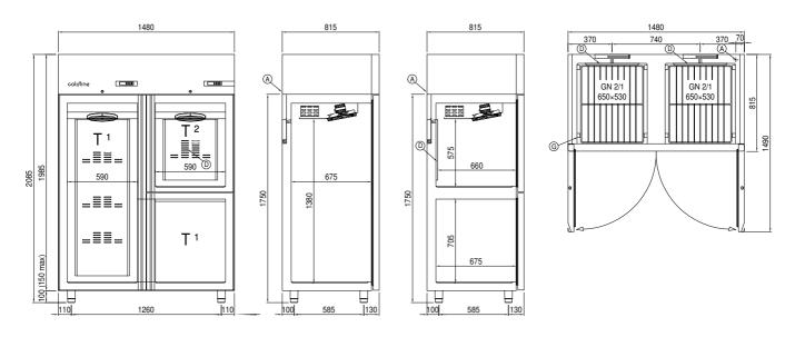
A: Stromanschluss D: Luftstrom Diffusor G: Stellleisten Steigung
