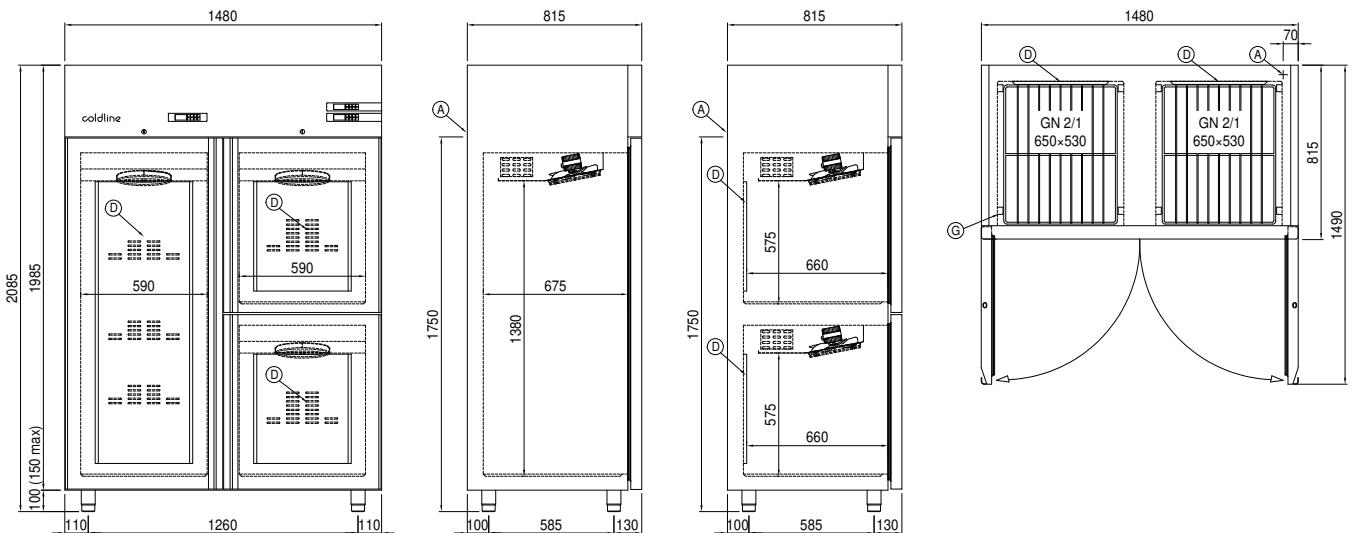
A: Alimentación del cable de salida
