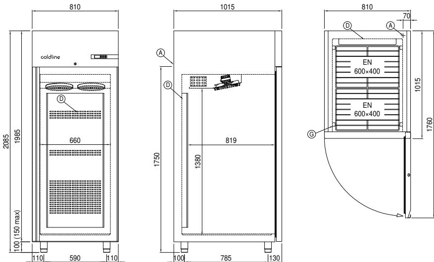
A: Alimentación del cable de salida
