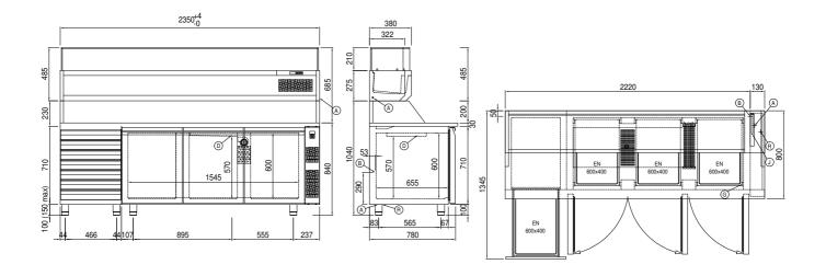
A: Uscita cavo alimentazione B: Scarico condensa D: Diffusore flusso aria
