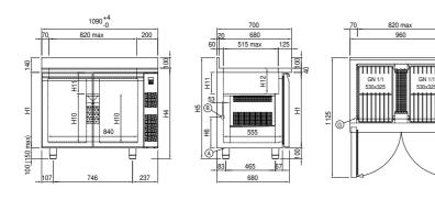
A: Uscita cavo alimentazione B: Scarico condensa G: Cremagliere
