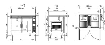
A: Uscita cavo alimentazione B: Scarico condensa G: Cremagliere
