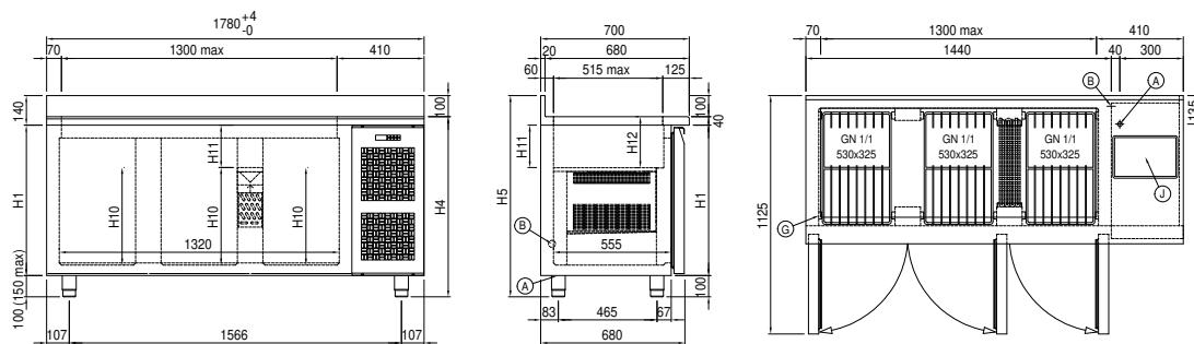
A: Alimentación del cable de salida
