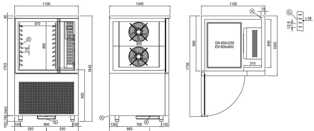
A: Alimentación del cable de salida
