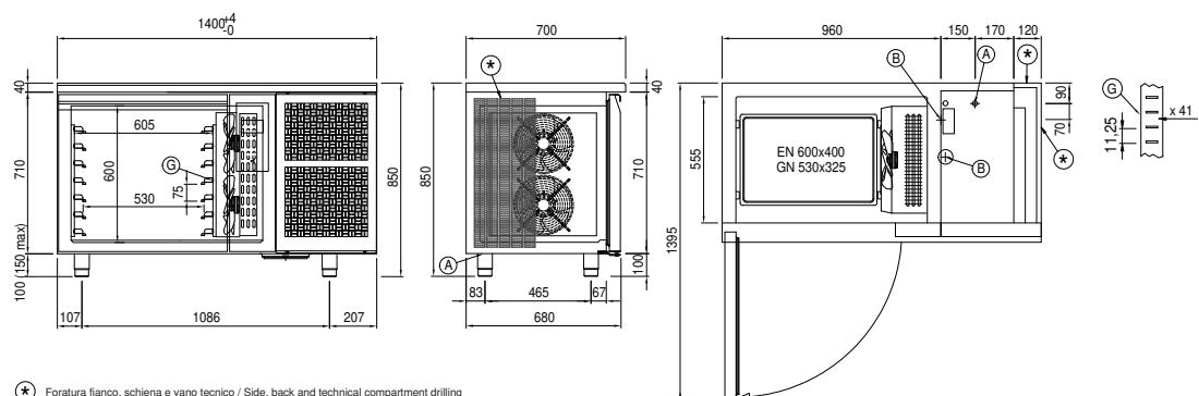
A: Alimentación del cable de salida
