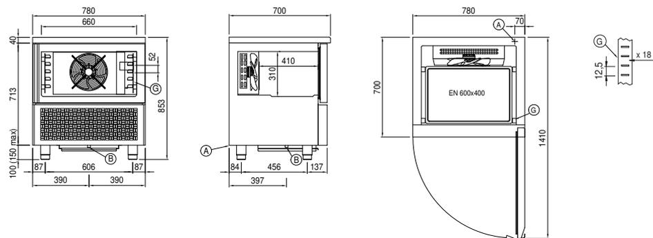
A: Alimentación del cable de salida      B: Descarga del agua de condensación      G: Cremalleras
