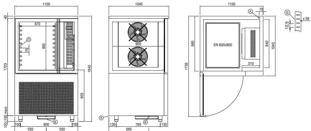
A: Alimentación del cable de salida
